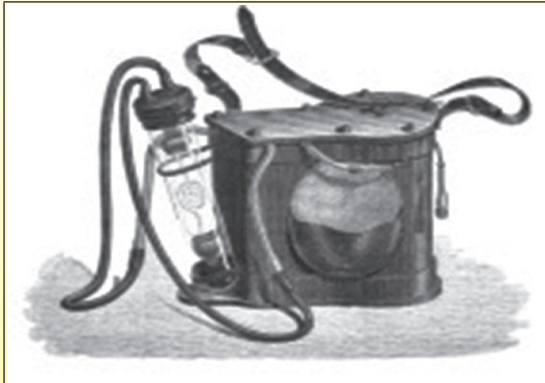
1862 Lampe électrique de mineur Dumas et Benoît
